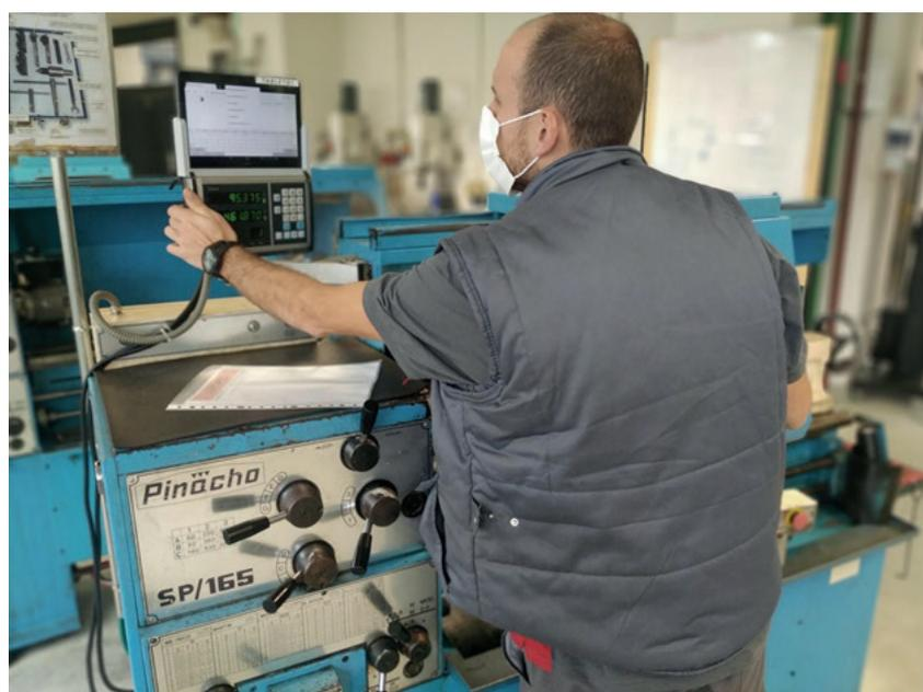
Figura 3: profesor utilizando una hoja de proceso digital realizada en la plataforma Odoo (ERP) en el dispositivo táctil digital de la máquina.
