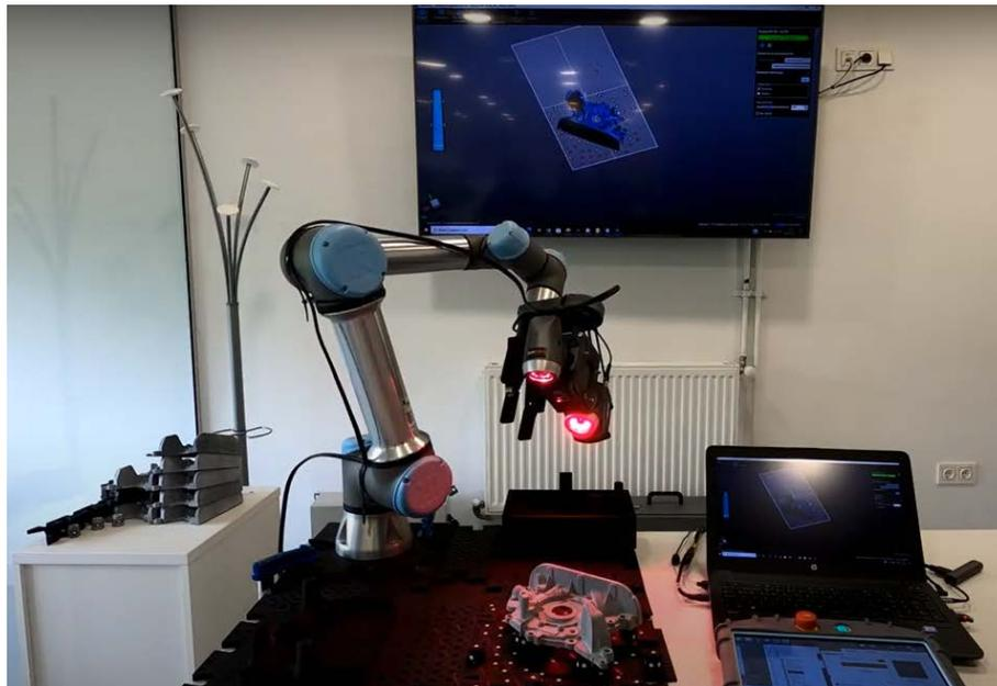
Abbildung 67: 3D-Scanner integriert in einen kollaborativen Roboter. Quelle: HVET Miguel Altuna und HVET Tolosaldea
