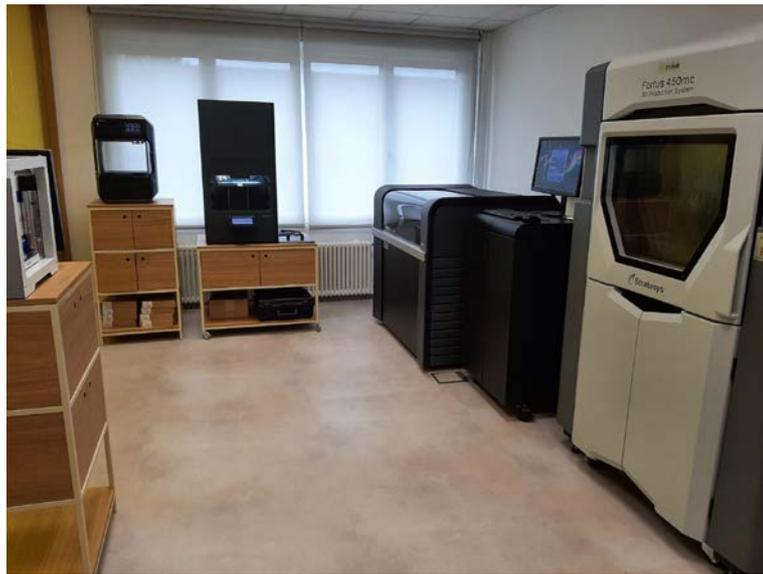
Abbildung 76: Ika-lab-Maschinen von Tknika (FDM, Polyjet und ADAM). Quelle: Tknika
