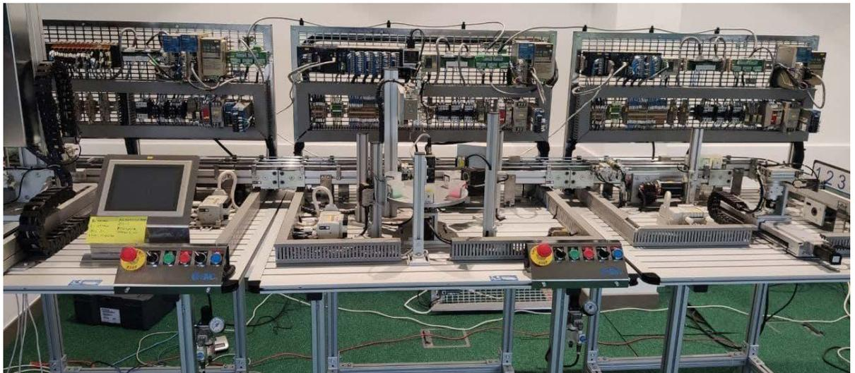
Abbildung 38: Omrom-SPS-Bereich. Quelle: Tknika
