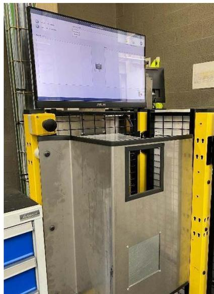
Abbildung 61: Benutzer- und Werkzeugausgangsdetektor mit RFID-System im Labor von Miguel Altuna. Quelle: Miguel Altuna
