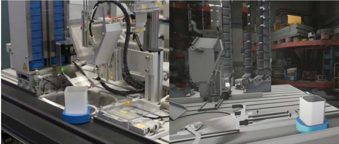
Abbildung 44: Links die reale Maschine und rechts der digitale Zwilling der SMC SIF400 Maschine. Quelle: Tknika
