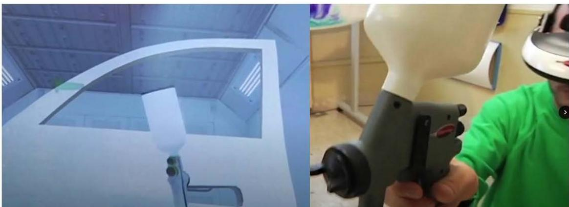
Abbildung 45: Student arbeitet an einem digitalen Zwilling der Autolackierung. Quelle: Tknika
