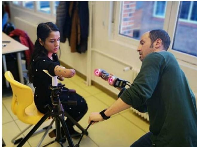
Abbildung 33: Scannen von Marias Arm mit dem Creaform Handyscan 700 Scanner. Quelle: Tknika
