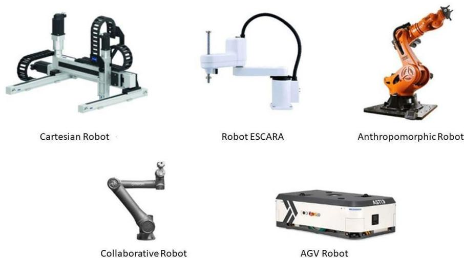
Abbildung 64: Robotertypen. Quelle: <https://www.vld-eng.com/blog/tipos-de-robots-industriales/>
