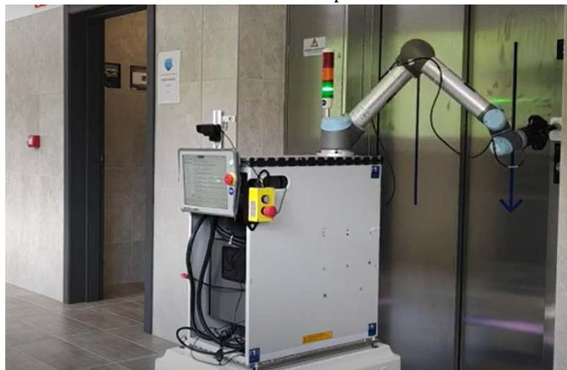
Abbildung 69: Roboter ruft den Aufzug an. Quelle: Miguel Altuna
