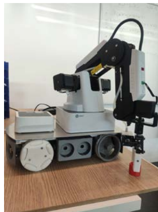
Abbildung 94: EXAM-Roboter mit Dobot-Magier an der Spitze als Anwendung zum Aufnehmen von Objekten. Quelle: DHBW
