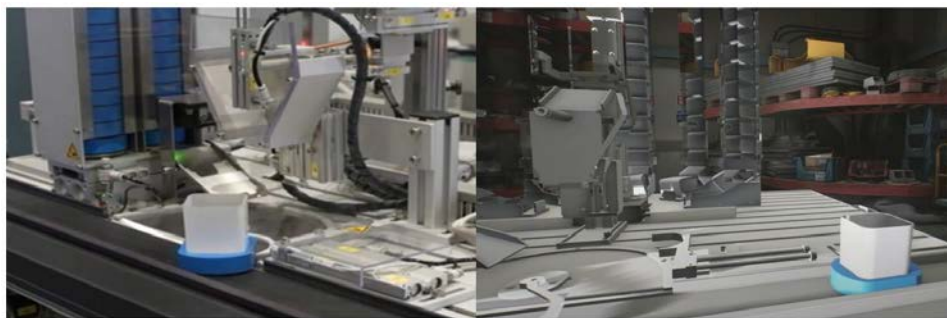
Abbildung 35: Links die reale Maschine und rechts der digitale Zwilling der SMC SIF400-Maschine. Quelle: Tknika
