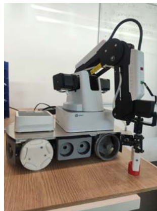
Abbildung 41: EXAM-Roboter mit Dobot-Magier an der Spitze als Anwendung zum Aufnehmen von Objekten. Quelle: DHBW
