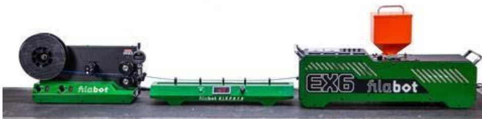
Abbildung 9: Die Filabot-Maschine verwandelt Granulat in Filament für 3D-Drucker. Quelle: Da Vinci
