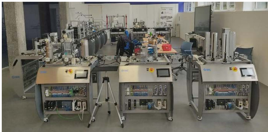
Abbildung 23: Didaktische Ausrüstung von SMC für Industrie 4.0 SIF-400. Quelle: Tknika
