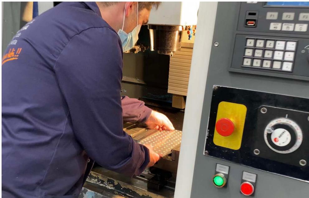
Abbildung 72: Student bei der Herstellung der Hauptplatte in einer CNC-Fräsmaschine. Quelle: Miguel Altuna
